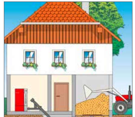
Tussen houtsnipperopslag en stookruimte een inlooppassage/gang (hellende vijzel)
